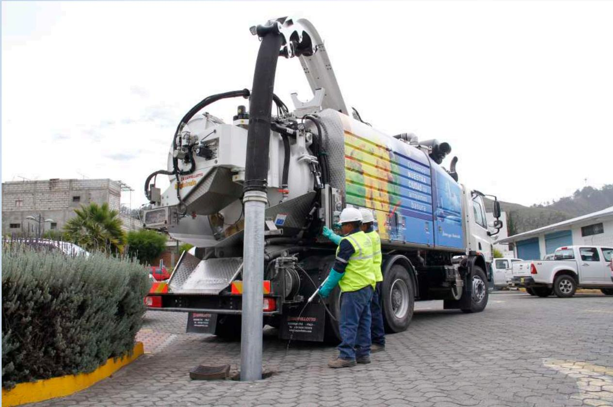
Adquisición de dos nuevos hidrosuccionadores con tecnología de punta que están en funcionamiento en beneficio de la ciudadanía a partir del segundo semestre del año 2018. Es un gran aporte al mantenimiento adecuado de los sistemas de alcantarillado existentes.
